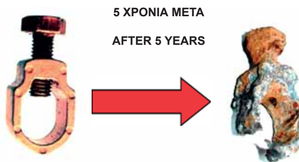
Εικόνα Β7. Σφιγκτήρας ηλεκτροδίου γείωσης όχι σύμφωνος με το ΕΛΟΤ EN 50164-1 Figure B7. Rod clamp not complying with European Standard EN50164-1
