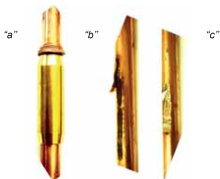
Εικόνα Β6. "a", "b" ράβδοι γείωσης με μανδύα χαλκού, "c" ράβδος γείωσης με ηλεκτρολυτική επικάλυψη. Figure B6. "a," "b" copper sheathed earth rods, "c" copper intrinsically bonded earth rod
