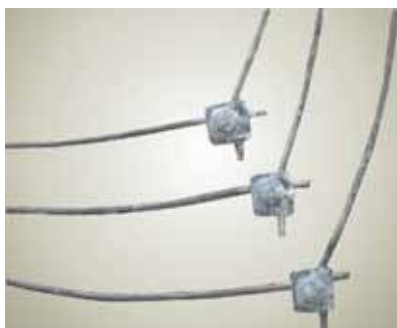
Δοκίμιο μετά την τεχνητή γήρανση και μετά τις ηλεκτρικές δοκιμές, 3 βολές, 100kA, 10/350μs
