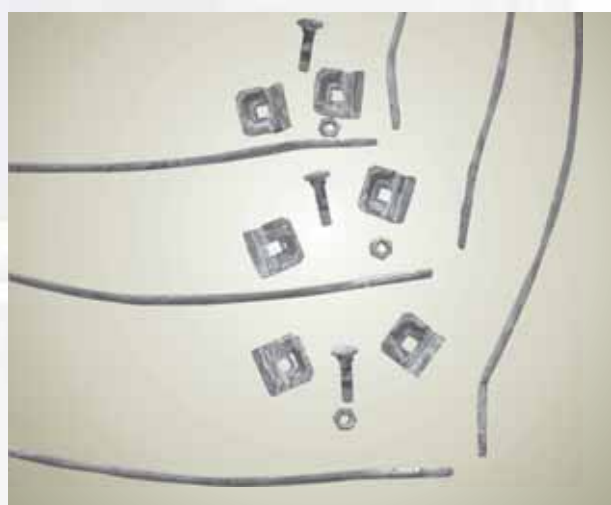
Εικόνα 14: Δοκίμιο λυμένο μετά το πέρας όλων των δοκιμών
