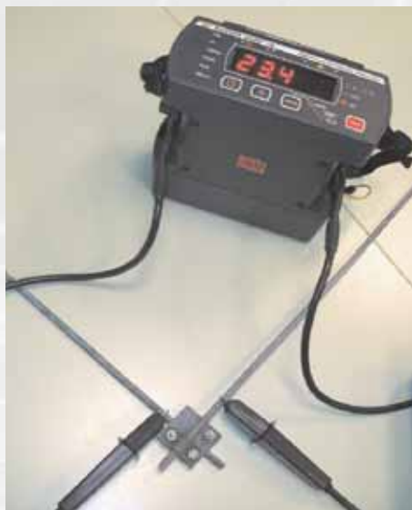
Εικόνα 12: Μέτρηση αντίστασης διάβασης με πηγή ρεύματος 10A (DC) μετά την τεχνητή γήρανση και τις ηλεκτρικές δοκιμές
