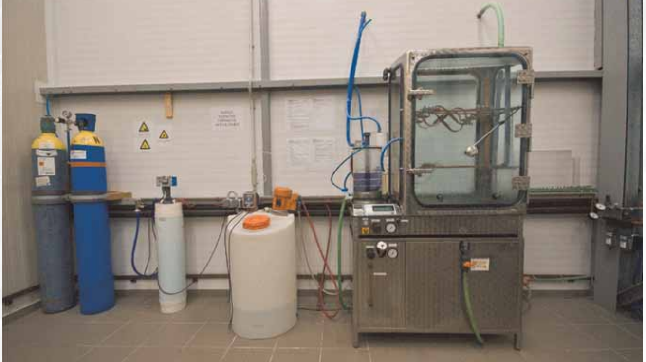
Εικόνα 3: Θάλαμος τεχνητής γήρανσης αλατονέφωσης και θειϊκής ατμόσφαιρας - ΕΛΕΜΚΟ ΑΒΕΕ
