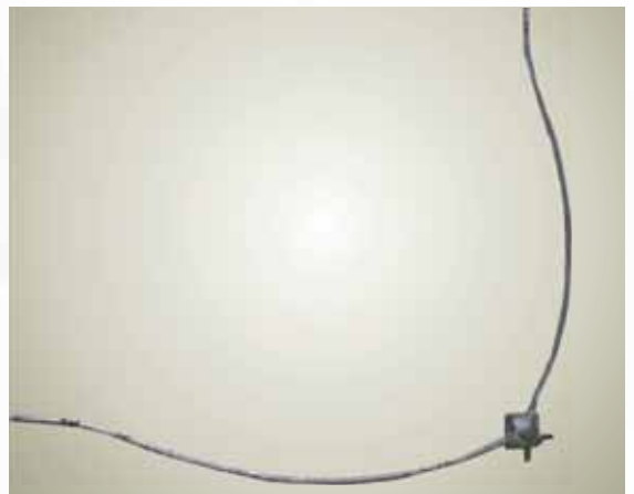
Εικόνα 11: Δοκίμιο μετά την τεχνητή γήρανση και μετά τις ηλεκτρικές δοκιμές, 3 βολές, 100kA, 10/350μs
