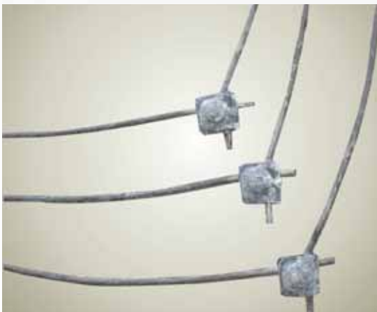
Εικόνα 10: Δοκίμιο μετά την τεχνητή γήρανση και μετά τις ηλεκτρικές δοκιμές, 3 βολές, 100kA, 10/350μs
