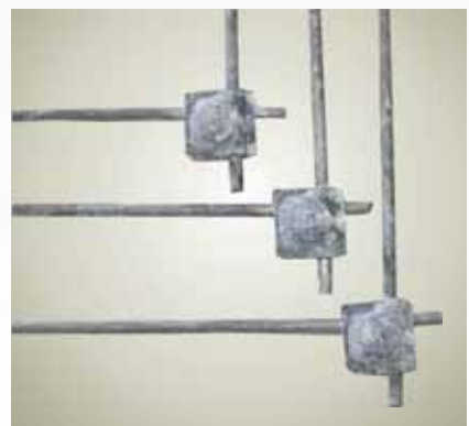
Εικόνα 7: Δοκίμιο εικόνας 6 μετά την τεχνητή γήρανση
