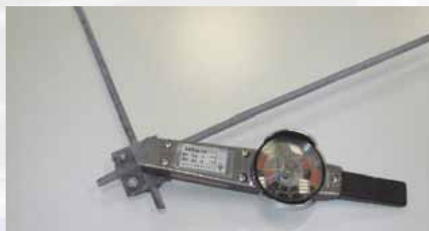
Εικόνα 13: Έλεγχος ροπής λύσης μετά την τεχνητή γήρανση, τις ηλεκτρικές δοκιμές και τη μέτρηση της αντίστασης διάβασης
