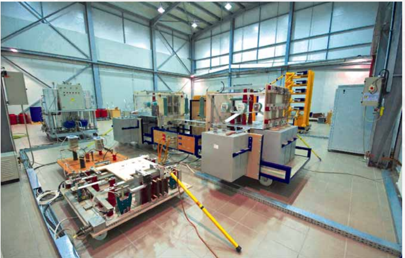
Εικόνα 9: Γεννήτρια παραγωγής ρεύματος 100kA κυματομορφής 10/350μs - ΕΛΕΜΚΟ ΑΒΕΕ
