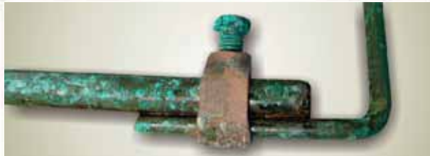
Εικόνα 23: Δοκίμιο (Β) εικόνας 22 μετά την τεχνητή γήρανση, χωρίς σημάδια διάβρωσης. Ικανοποίηση κριτηρίων προτύπου ΕΛΟΤ EN 62561-2:2017 ΚΑΤΑΛΛΗΛΟ ΓΙΑ ΧΡΗΣΗ
