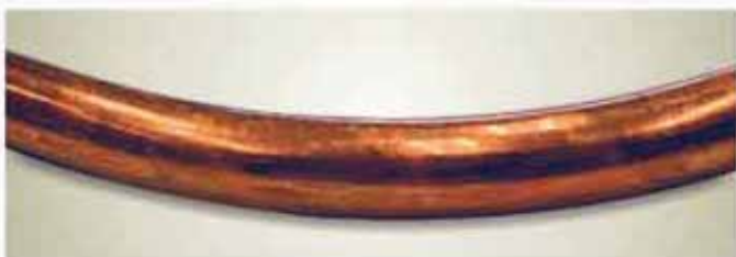
Εικόνα 11: Δοκίμιο (Β) καινούργιο πριν την τεχνητή γήρανση (πάχος ηλεκτρολυτικής επιχάλκωσης 250μm)
