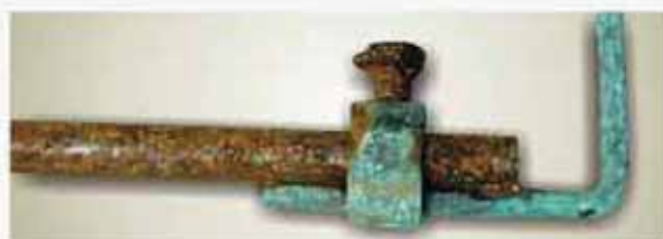
Εικόνα 21: Δοκίμιο (Α) εικόνας 20 μετά την τεχνητή γήρανση, με εμφανή διάβρωση. Απόρριψη λόγω μη ικανοποίησης κριτηρίων προτύπου ΕΛΟΤ EN 62561-2:2017 ΑΚΑΤΑΛΛΗΛΟ ΓΙΑ ΧΡΗΣΗ
