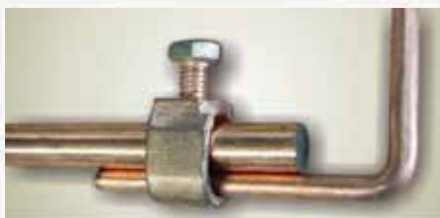
Εικόνα 20: Δοκίμιο (Α) καινούργιο πριν την τεχνητή γήρανση [επιχάλκωση ράβδου 20μm & υλικό σφιγκτήρα κράμα αλουμινίου (σώμα) και χάλυβα (κοχλίας) βαμμένο στο χρώμα του χαλκού]
