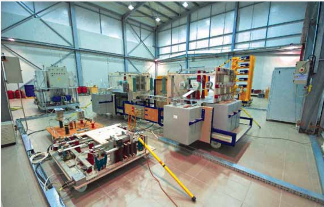
Εικόνα 25: Γεννήτρια παραγωγής ρεύματος 100kA κυματομορφής 10/350μs - ΕΛΕΜΚΟ ΑΒΕΕ
