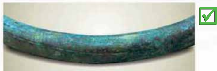
Εικόνα 12: Δοκίμιο (Β) εικόνας 11 μετά την τεχνητή γήρανση χωρίς σημάδια διάβρωσης ΚΑΤΑΛΛΗΛΟ ΓΙΑ ΧΡΗΣΗ
