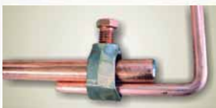
Εικόνα 22: Δοκίμιο (Β) καινούργιο πριν την τεχνητή γήρανση [ηλεκτρολυτική επιχάλκωση ράβδου 250μm & υλικό σφιγκτήρα κράμα χαλκού (σώμα και κοχλίας) περιεκτικότητας 70% σε χαλκό]
