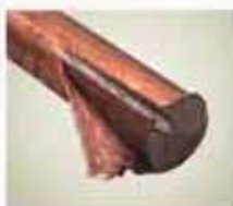
Εικόνα 4: Ράβδος γείωσης με επιχάλκωση από μανδύα χαλκού ΑΚΑΤΑΛΗΛΟ ΓΙΑ ΧΡΗΣΗ
