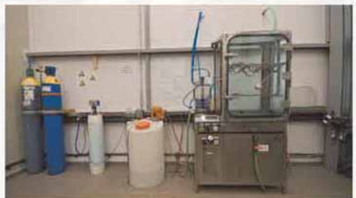
Εικόνα 8: Θάλαμος τεχνητής γήρανσης αλατονέφωσης και θειϊκής ατμόσφαιρας - ΕΛΕΜΚΟ ΑΒΕΕ
