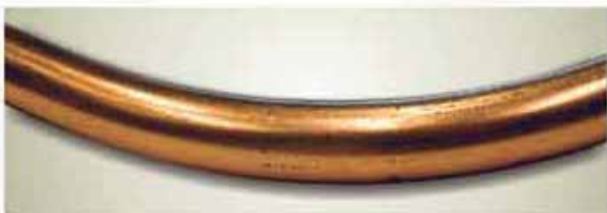
Εικόνα 9: Δοκίμιο (Α) καινούργιο πριν την τεχνητή γήρανση (πάχος επιχάλκωσης 20μm)
