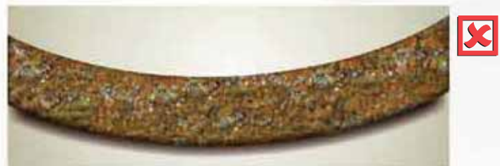
Εικόνα 10: Δοκίμιο (Α) εικόνας 9 μετά την τεχνητή γήρανση με εμφανή διάβρωση ΑΚΑΤΑΛΛΗΛΟ ΓΙΑ ΧΡΗΣΗ
