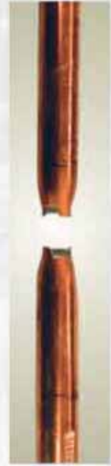
Εικόνα 14: Ράβδος γείωσης μετά την δοκιμή εφελκυσμού
