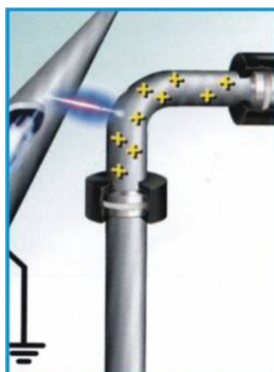
Εικόνα 2: Δημιουργία σπινθήρα μεταξύ αγείωτων αγωγίμων μερών που δημιουργήθηκε από στατικό ηλεκτρισμό
