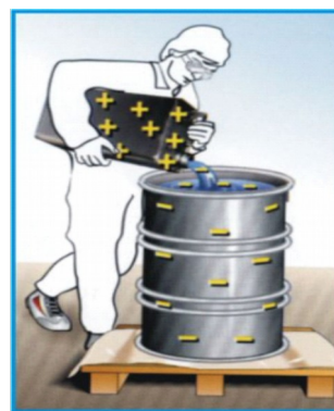
Εικόνα 3: Δημιουργία στατικού ηλεκτρισμού από ροή υγρών
